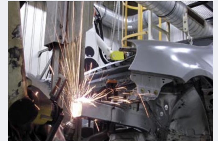
In der Fertigungszelle bei VW wird gemessen, geschnitten und geschweißt.
